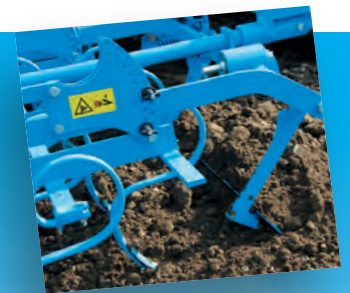
Підпружинений брус з позиціями „на зріз” чи „на згладжування” для оптимального вирівнювання.
