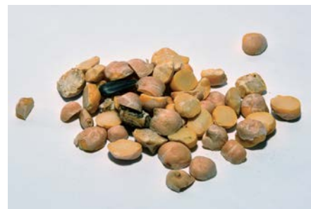
Рис. 18. Фрагмент суміші половинок насіння нуту і співрозмірного сміття, що пройшло через решето Фадєєва 5,5 мм
