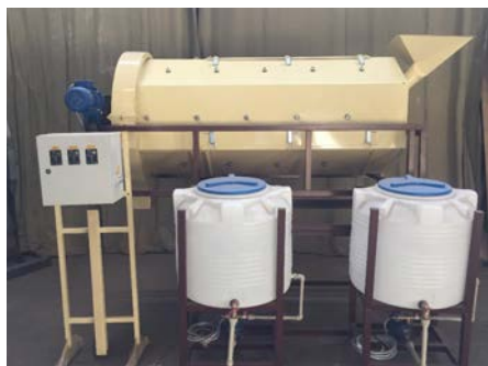
Рис. 4. Протравлювач насіння Фадєєва (ПСФ)
