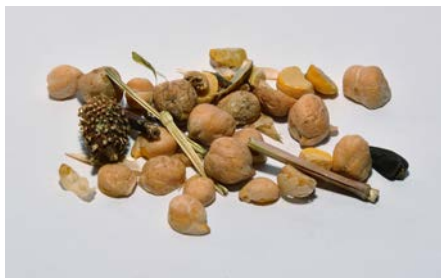
Рис. 14. Фрагмент суміші цілих зерен нуту, половинок і сміття, яка зійшла із середніх сходів аеросепаратора
