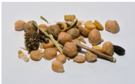
Рис. 14. Фрагмент суміші цілих зерен нуту, половинок і сміття, яка зійшла із середніх сходів аеросепаратора
