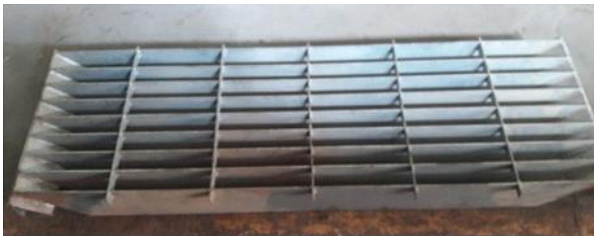
Рис. 40. З таких модулів складається приймальний пристрій
