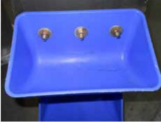
Рис. 27. «Нетравмующі» ковші з болтами, що стирчать
