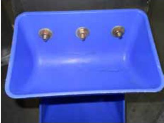
Рис. 27. «Нетравмирующие» ковши с торчащими болтами
