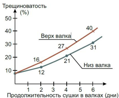
Рис. 19. Повышение трещиноватости риса при сушке его в валах в зависимости от времени сушки (дни)
