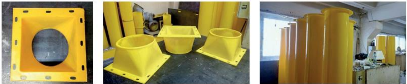
Рис. 36. Футеровка полиуретаном, выполняемая НПП «Форполимер» (г. Харьков)
