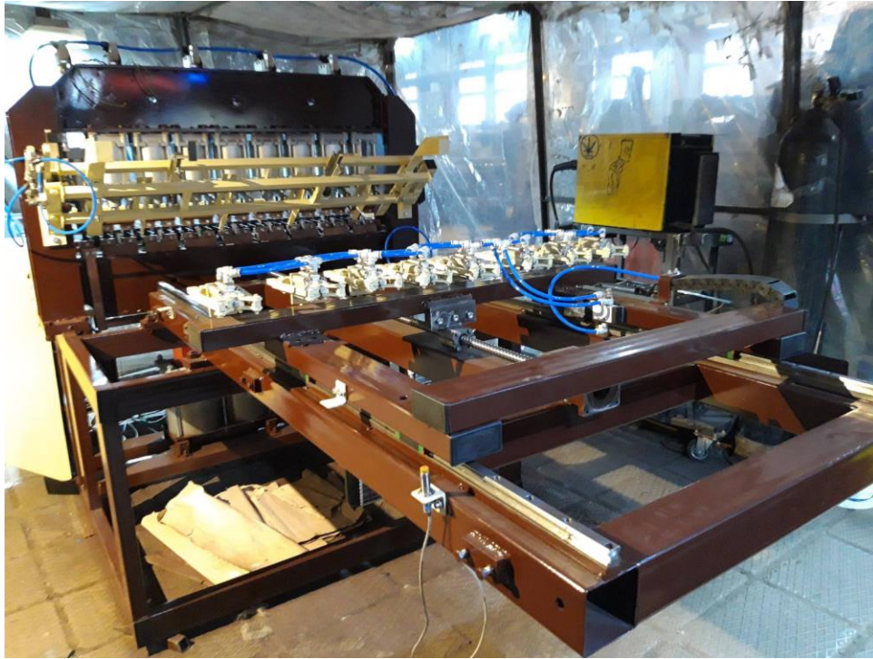
Рис. 5. Устаткування для виробництва решіт з необхідною точністю багатоточкового зварювання
