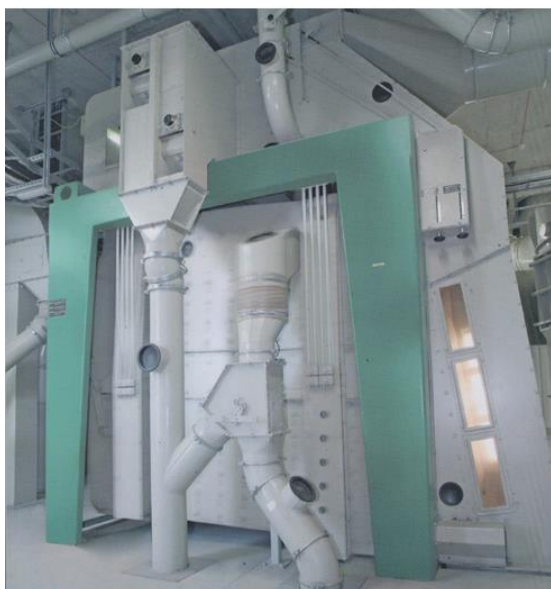
Рис. 20. Внешний вид и функциональная схема зерноочищающей машины серии Schmidt-Seeger TASTM («Buhler»)
