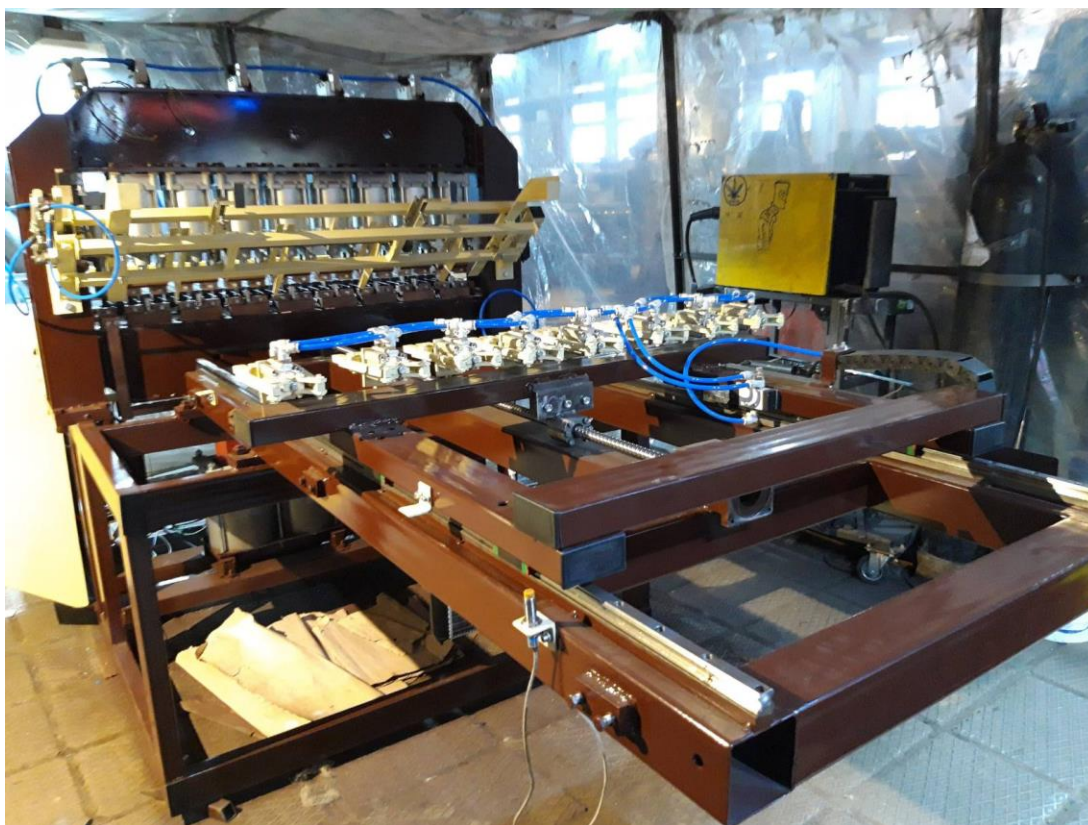
Рис. 5. Оборудование для производства решет с требуемой точностью многоточечной сварки
