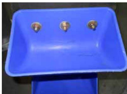
Рис. 7. «Нетравмуючі» ковші з болтами, що стирчать
