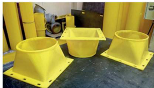
Рис. 16. Футерування поліуретаном, що виконується НВП «Форполімер» (м. Харків)
