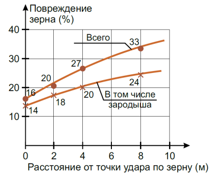
Рис. 2. Ушкодження зерна (зокрема і його зародка) залежно від дальності його метання зернометальником
