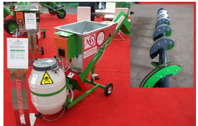
Протруювач насіння шнековий ПНШ-3 (ПП) «Фермер» з лопатковим шнеком
