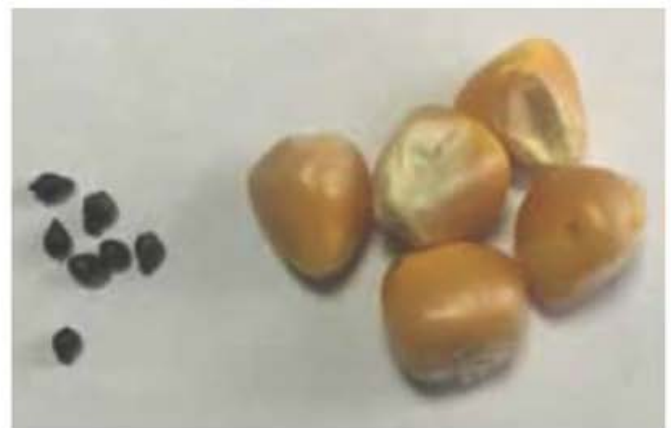
Рис. 52. Співвідношення розмірів насіння амброзії та кукурудзи, не розділених на барабанному сепараторі
