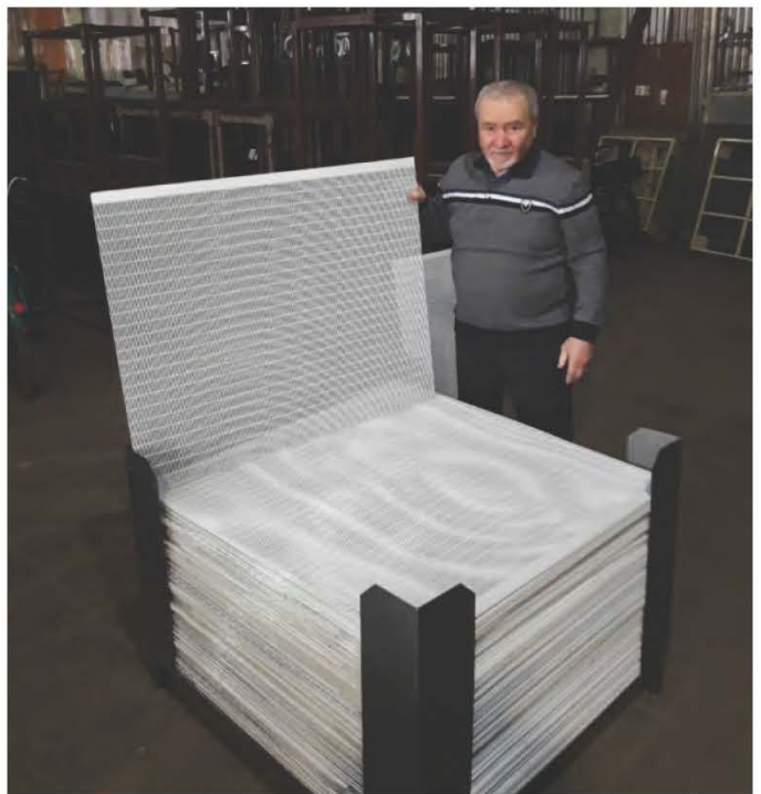
Рис. 46. Комплект решіт для насінневого заводу з підготовки СИЛЬНОГО НАСІННЯ культур, що знаходяться в сівозміні
