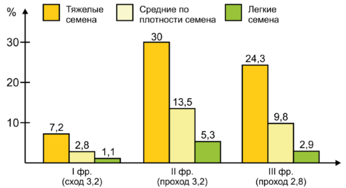
Рис. 74. Пофракційна сепарація за щільністю насіння ячменю на пневмовібростолі ПВСФ
