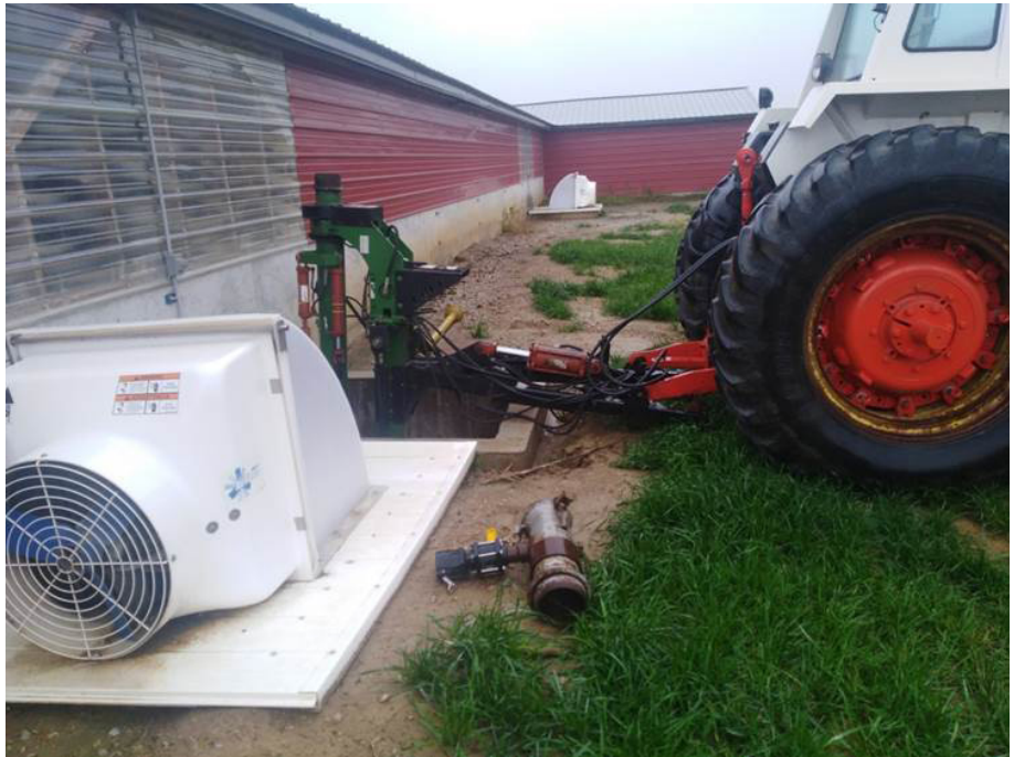
Рис. 5. Забір гною з глибокої ванни із дотриманням відповідних норм техніки безпеки
