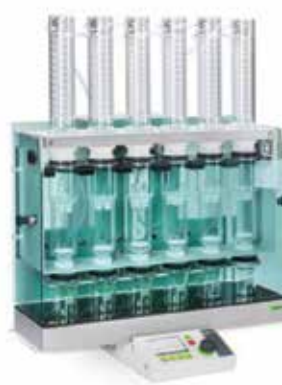
Рис. 3. 6-позиционный экстрактор E-816 ECE (производства VÜCHI Labortechnik AG)
