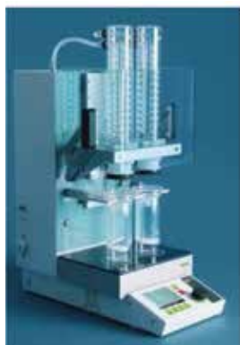
Рис. 2. 2-позиционный экстрактор по методу горячей экстракции E-812-HE (производства VÜCHI Labortechnik AG)
