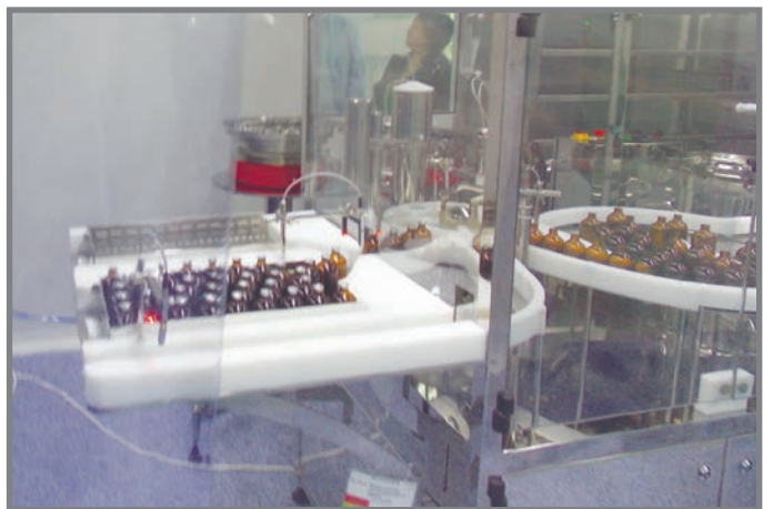
Линия розлива стерильных лекарственных средств (100 мл) расположена под ламинарной установкой, обеспечивающей необходимый класс чистоты В (А).
