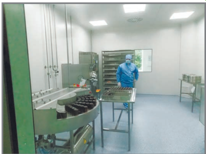
Зона подготовки первичной упаковки. Проводится мойка флаконов и их дальнейшая депирогенизация, а также подготовка к стерилизации пробок и колпачков (флакон стеклянный – 100 мл).
