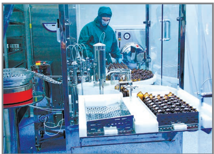
Линия розлива стерильных лекарственных средств (100 мл) расположена под ламинарной установкой, обеспечивающей необходимый класс чистоты В (А).
